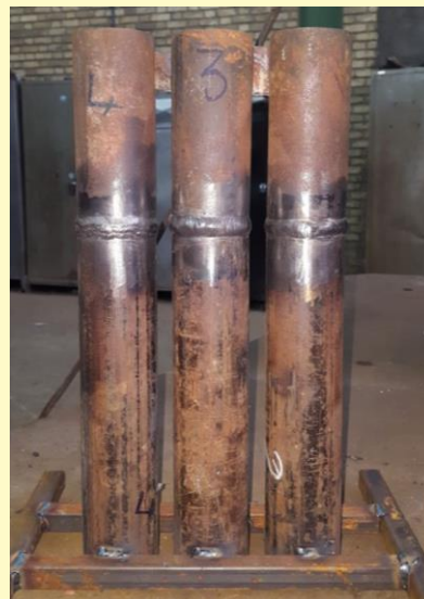
شکل ۴- لوله های جوش داده شده مشابه لوله های واتروال بویلر با عیوب تعمدی
